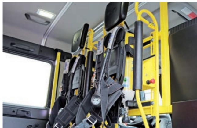
Zwei Fahrgestelle, zwei verschiedene Kabinen, eine Ziegler-spezifische Lösung für die Atemschutzgerätehalterung. Die Einflasengeräte sind sicher und schnell angelegt und bei angezogener Feststellbremse elektrisch entriegelt. Optional sorgen Zweipunktgurte für zusätzliche Sicherheit während der Einsatzfahrt.
