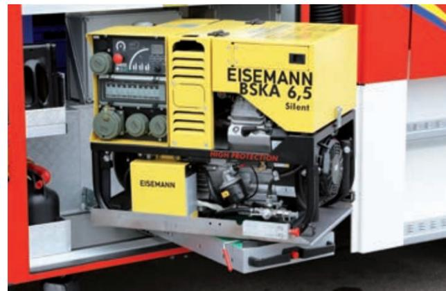
Der Stromerzeuger ist im tiefgezogenen Aufbaubereich drehbar auf einem teleskopierbaren Schwerlastauszug gelagert. Dadurch ist es dem Maschinisten möglich, das Aggregat in Betrieb zu nehmen, ohne es aus dem Fahrzeug entnehmen zu müssen.
