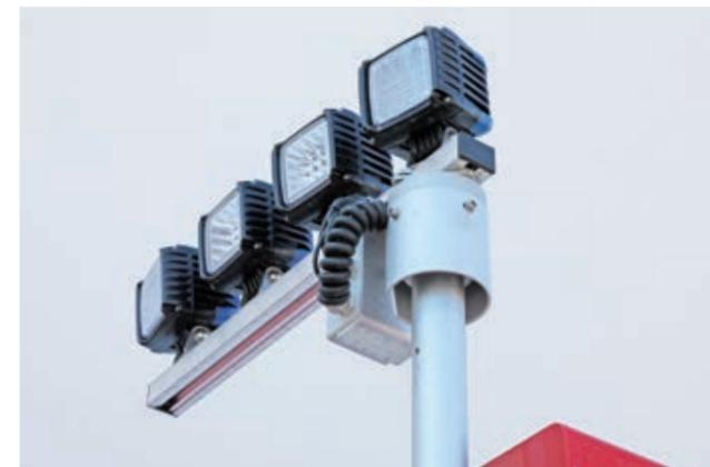
Ein mit vier Halogenstrahlern ausgestatteter, pneumatisch auf ca. 4,50 Meter ausfahrbarer Lichtmast sorgt für eine großzügige Ausleuchtung des Fahrzeugumfelds und der Einsatzstelle.
