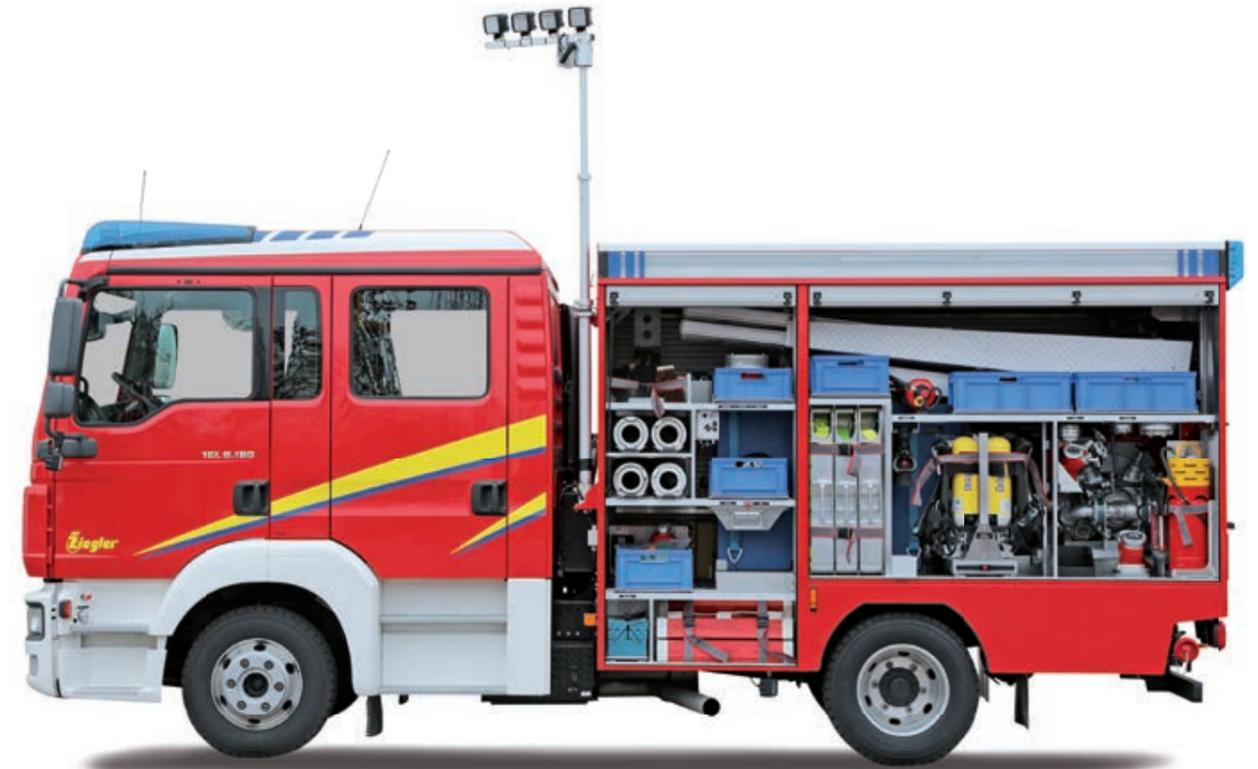
Das 7,49 t-Straßenfahrzeuggestell mit Niederquer- schnittreifen sorgt für sehr gute Fahreigen- schaften und ergonomische Entnahmehöhen. Der tiefgezogene Gerätekoofferaufbau bietet
