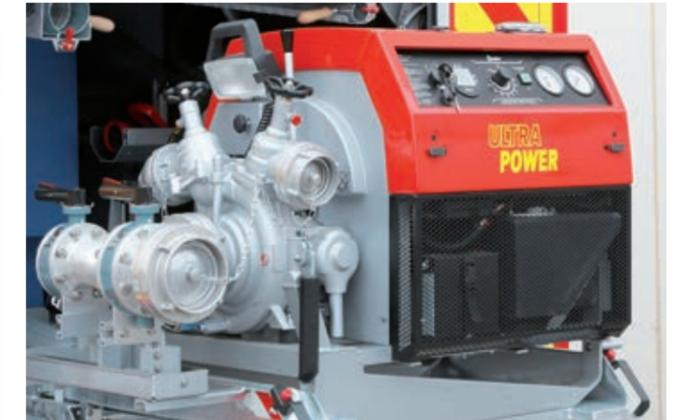
Die Tragkraftspritze ist heckseitig quer auf einem Schwerlastauszug gelagert. Sie kann im herausgezogenen Zustand betrieben werden und ist mit einem Kombisaugstutzen direkt am Wassertank angeschlossen. Ein schnelles Umschalten von Tanksaug- auf Fremdsaugbetrieb erspart ein zeitintensives Trennen der Pumpe.
