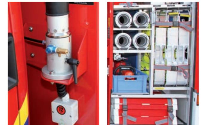
Der zwischen Kabine und Aufbau gut zugänglich montierte Lichtmast kann mittels Fahrgestellauszufahren werden.
