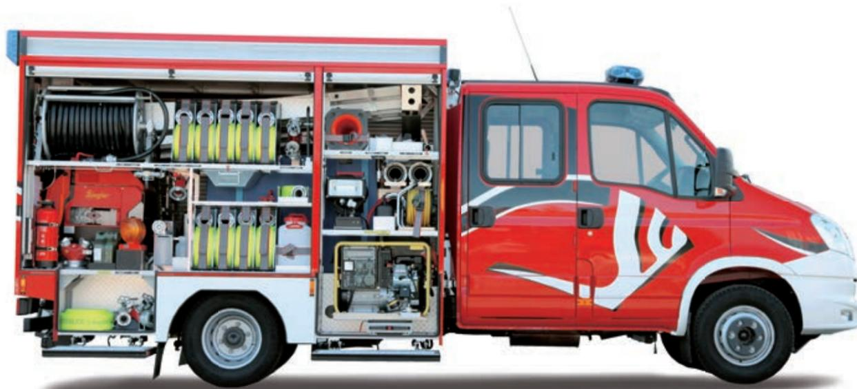
Der im Ziegler ALPAS-System gefertigte Gerätekoofferaufbau ist in fünf Geräteräume aufgeteilt, die individuell bestückt und nachträglich verändert werden können.
