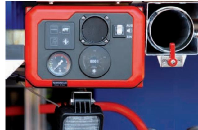
Das kompakte Maschinistendisplay ermöglicht die Kontrolle der gewählten Betriebsart. Ein integrierter Lautsprecher überträgt den Funkverkehr zum Fahrzeugheck.
