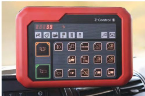
Maschinist und Gruppenführer können alle wichtigen Funktionen über das drehbar am Armaturenbrett angeordnete Z-Control-Bedientableau überblicken und steuern. Die ergonomisch konzipierten Schaltelemente sind klar und übersichtlich gestaltet.
