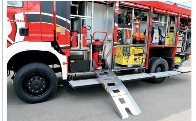
Der fahrbare 50-kg-Pulverlöscher kann mittels einer ausklappbaren Rampe über die Bordwandklappe hinweg bis auf den Boden gerollt werden.
