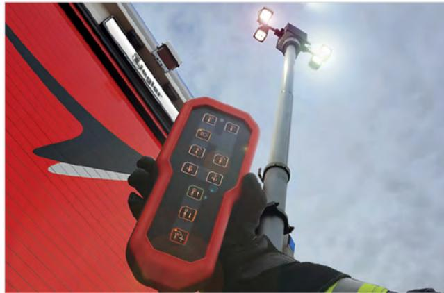
Halteschlaufen und große Tasten machen das Z-Control-Bedientableau auch mit Handschuhen sicher bedienbar. Über das Tableau kann man den pneumatischen Lichtmast ausfahren, die 6 leistungsstarken LED-Scheinwerfer bis 360° in die gewünschte Richtung drehen und in zwei getrennte Bereiche neigen.
