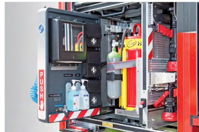
„PUSH“: Beim Hygieneboard ist der Name Programm. Ein „PUSH“ mit dem Ellenbogen genügt, dann stehen Wasserhahn, Seife, Handtücher und Druckluftpistole zur Erstreinigung an der Einsatzstelle zur Verfügung. Alle Oberflächen sind reinigungsfreundlich ausgeführt.
