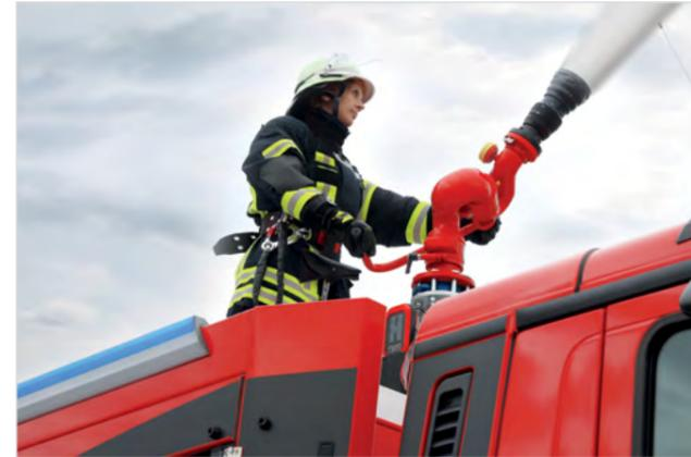
Der Dachwerfer lässt sich über das Z-Control-Bedientableau leicht bedienen.
