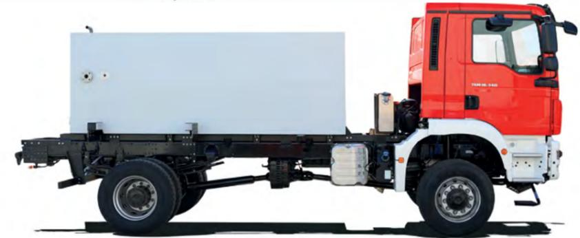
Die Löschmitteleinheit ist „ummantelt“ von ALPAS-Strukturen, die großzügigen Stauraum schaffen. Jeder Quadratcentimeter wird erschlossen und kann für die Unterbringungen von Ausrüstung genutzt werden. Die Löschmitteleinheit, bestehend aus einem 5000-l-Wassertank und zwei Schaumtanks mit 500/200 l, ist innenliegend verbaut. Das garantiert eine optimale Achslastverteilung und hervorragendes Fahrverhalten.
